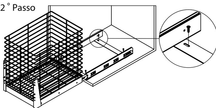
Puxe a Tulha(B) para fora e fixe a base da mesma no móvel utilizando os parafusos(B).
