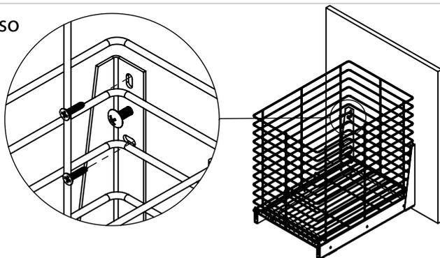
Insira os Parafusos(C) na chapa e os Parafusos(B) no móvel, sem apertar por completo. Regule utilizando os Parafusos(C) e fixe a Tulha(A) ao tampo do móvel apertando os Parafusos(B).
